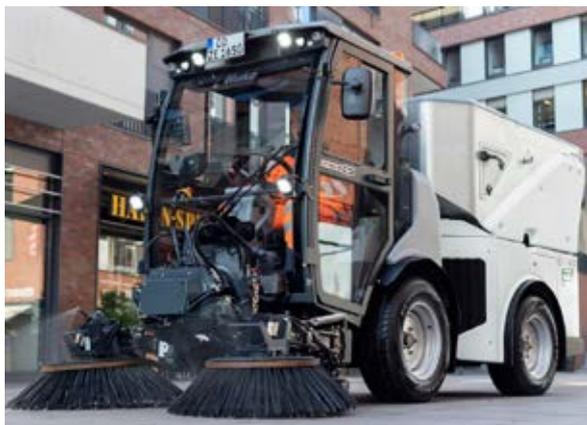
Ce printemps, les Services Techniques Municipaux ont réceptionné un nouveau véhicule porte-outils, plus puissant et plus maniable que le précédent. De la marque allemande Hako, ce nouveau véhicule peut être équipé de 3 balais rotatifs, pour mieux nettoyer les trottoirs en plus de la chaussée. Il permet également de passer le karcher dans des zones éloignées des points d'eau.
